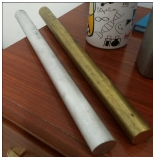
Figura 1 – Barras de alumínio e latão utilizadas para fabricação dos corpos de prova.
