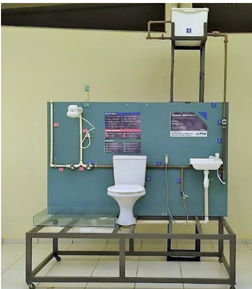
Figura 12 – Unidade educativa com base do reservatório posicionada a 0,95 metro do registro de gaveta presente na coluna de distribuição.
