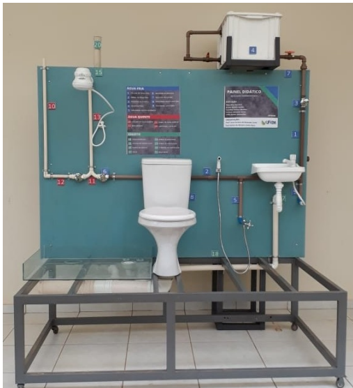
Figura 11 – Unidade educativa com base do reservatório posicionada a 0,28 metro do registro de gaveta presente na coluna de distribuição.
