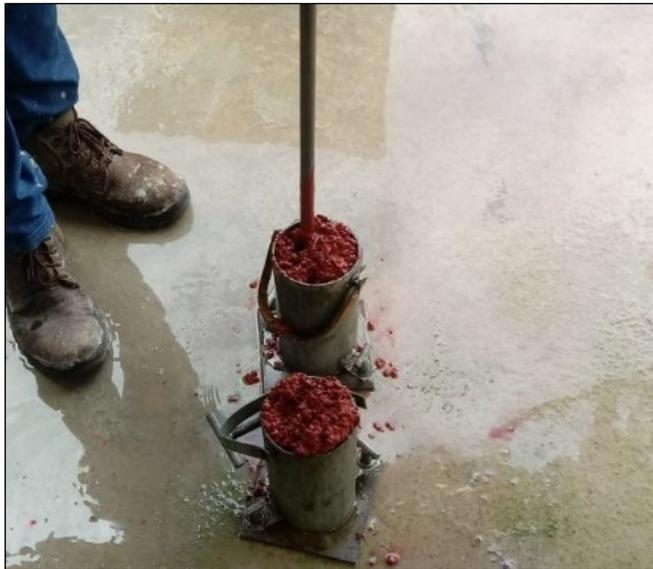
Figura 3 – Abatimento do concreto no corpo de prova.
