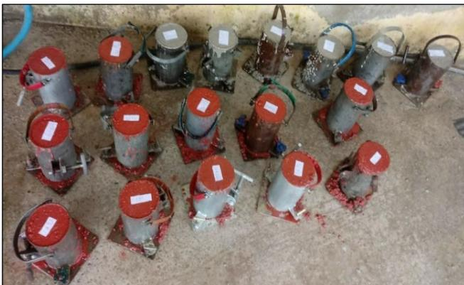
Figura 4 – Corpos de prova identificados e reservados em local adequado para seu endurecimento.
