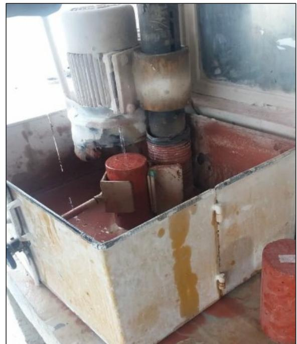
Figura 6 – Retificação dos Corpos de prova curados.
