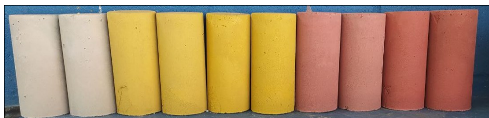
Figura 16 – Demonstração das cores obtidas aos 28 dias, na sequência REF, TA3, TA5, TV3 e TV5.
