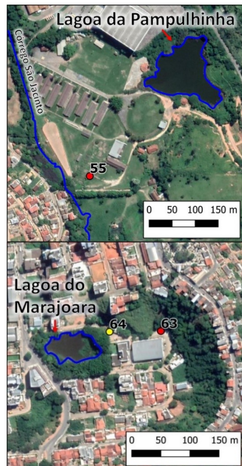
Figura 7 – O Poço 55 está localizado a cerca de 220m da Lagoa da Pampulhinha (painel superior) e o poço 63 a 120m da Lagoa do Marajoara (painel inferior). Ambas as lagoas são uma provável fonte de recarga para os dois poços de maior vazão na região de estudo.
