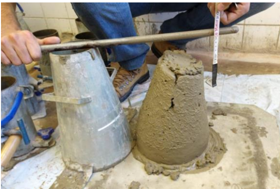
Figura 158 – Abatimento do tronco de cone.
