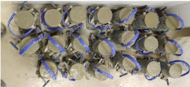
Figura 3 – Moldagem dos corpos de prova.
