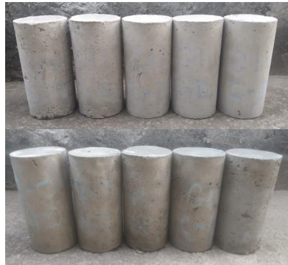
Figura 7 – Cura por aspersão.
