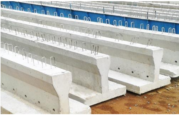
Figura 9 – Viga T em concreto armado. (Construtora Atlântica, 2021).
