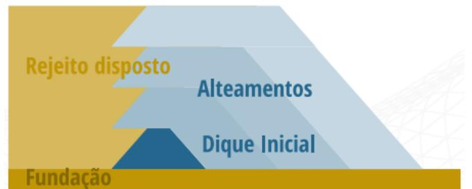
Figura 10 – Seção típica barragem de rejeitos no método de alteamento de linha de centro (ANA, 2019).
