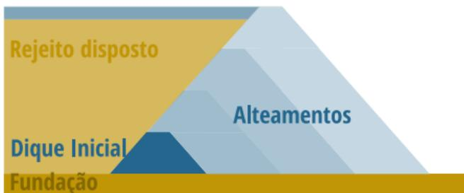
Figura 8 – Seção típica barragem de rejeitos no método de alteamento a jusante (ANA, 2019)
