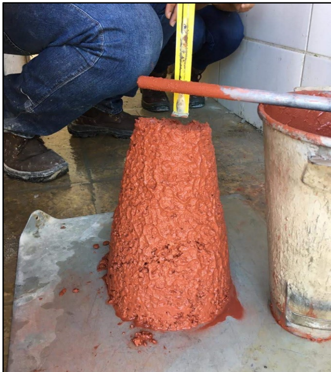
Figura 5 – Slump Test do concreto colorido.
