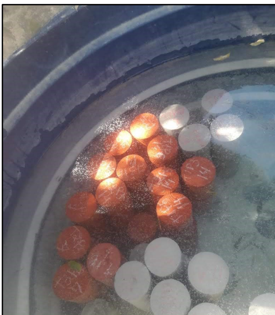
Figura 7 – Cura do concreto.
