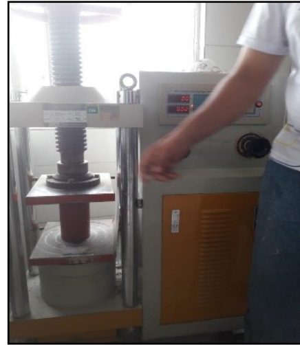
Figura 12 – Corpo de prova submetido ao ensaio de compressão em prensa elétrica.
