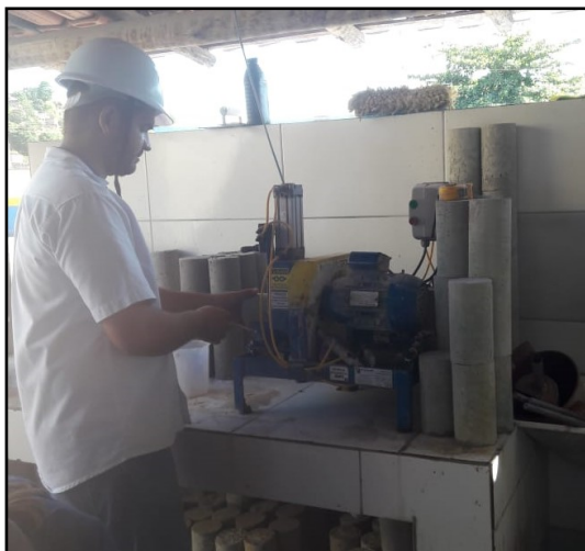
Figura 11 – Retificação dos corpos de prova de concreto.
