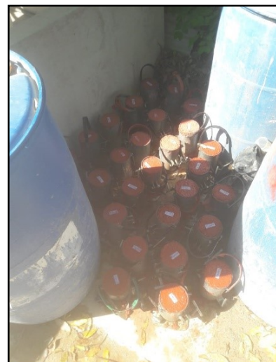
Figura 9 – Moldes preenchidos com as misturas adensadas.
