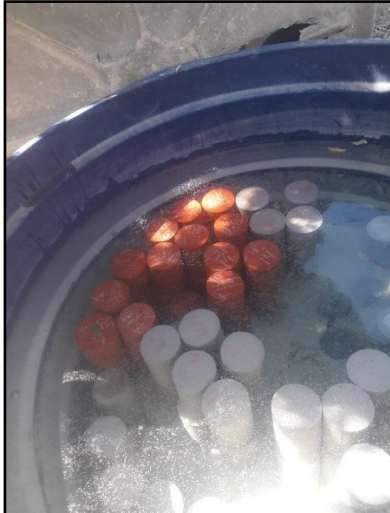
Figura 10 – Corpos de prova submetidos à cura úmida.
