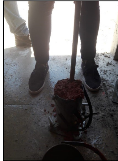
Figura 8 – Adensamento da mistura nos corpos de prova cilíndricos com auxílio da haste de aço.
