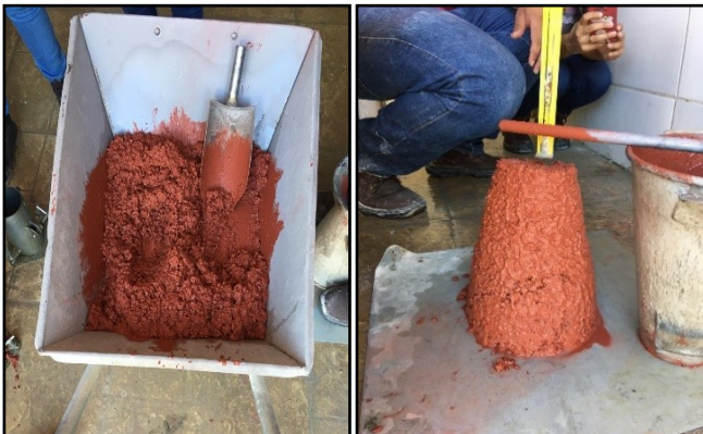
Figura 7 – A esquerda mistura de concreto colorido no estado fresco e a direita medida da consistência ( Slump Test ).
