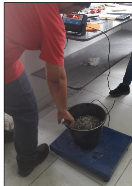
Figura 5 – Pesagem do agregado graúdo para a mistura do concreto.
