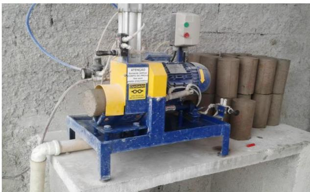
Figura 6 – Retificação dos corpos de prova.
