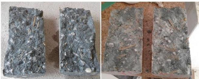
Figura 14 – Visualização das fibras o concreto rompido.
