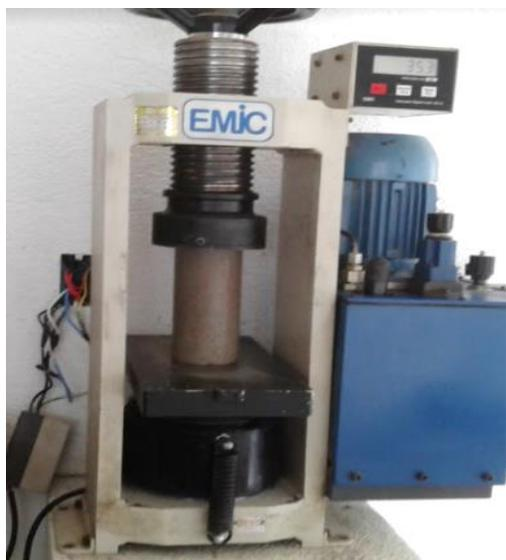
Figura 7 – Ensaio de Compressão Uniaxial.
