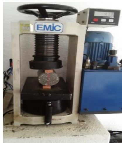
Figura 8 – Ensaio de Compressão Diametral.
