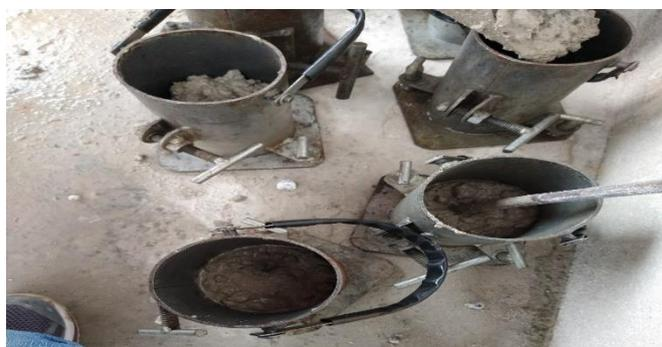
Figura 4 – Moldagem dos corpos de prova.
