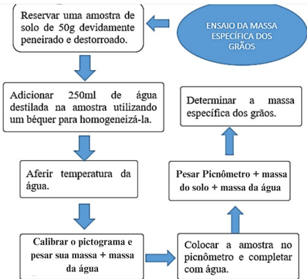
Figura 16 – Fluxograma de determinação da massa específica dos grãos com o primeiro método.
