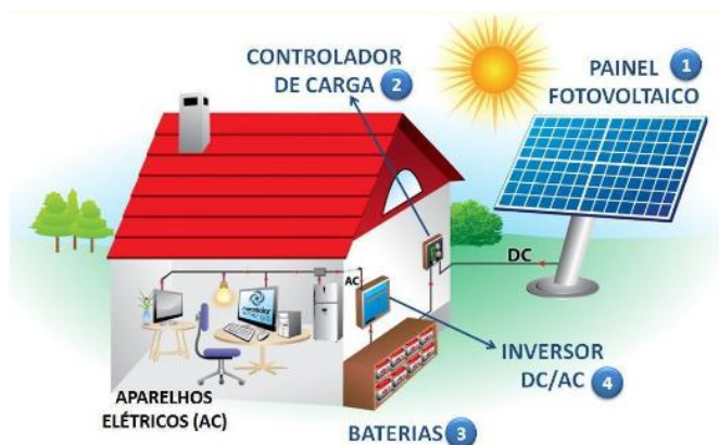
Figura 2 – Funcionamento de um sistema off-grid (Neosolar, 2022).
