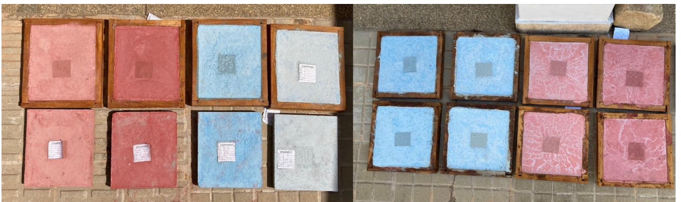
Figura 11 – Resultados comparativos visuais após 14 dias submetidos às intempéries da cidade de Teófilo Otoni – MG e colocadas em proteção.
