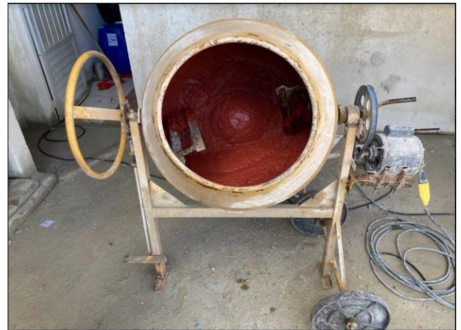
Figura 2 – Betoneira realizando a mistura dos agregados com adição de pigmento vermelho.
