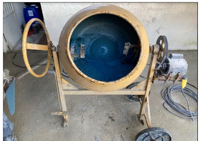
Figura 3 – Betoneira realizando a mistura dos agregados com adição de pigmento azul.
