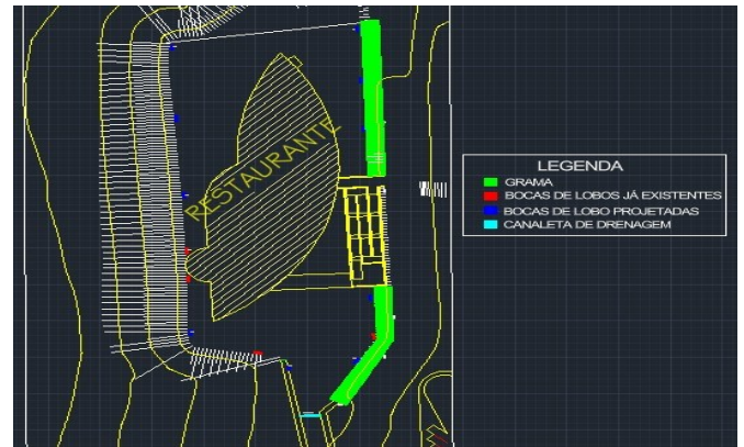
Figura 7 – Referências do sistema de drenagem.
