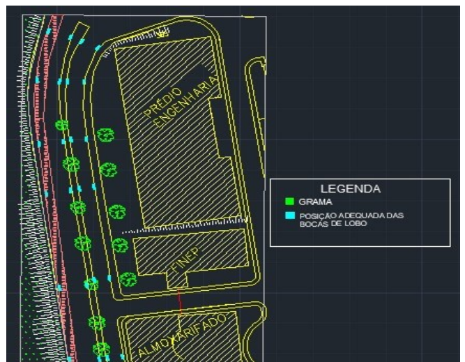
Figura 24 – Posição adequada das bocas de lobo.
