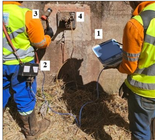
Figura 6 – Disposição do equipamento e equipe durante ensaio.
